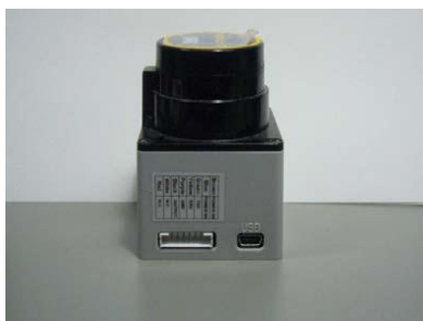
図 7 電源ケーブル用コネクタ (左) と USB ケーブル用コネクタ (右)
